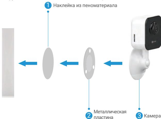
Рисунок 1. Монтаж на подкладку
